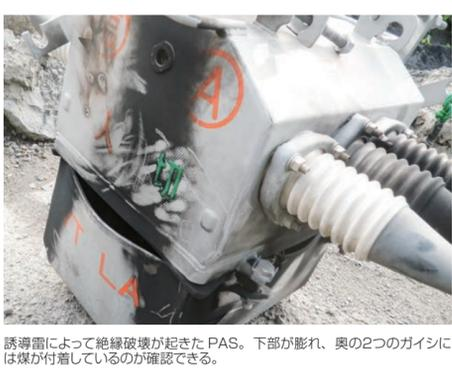
誘導雷によって絶縁破壊が起きたPAS。下部が崩れ、奥の2つのガイシには煤が付着しているのが確認できる。
