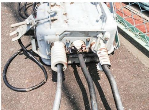
絶縁体による誘導電流によるPAS損傷例。緑色の絶縁体が破損している。
